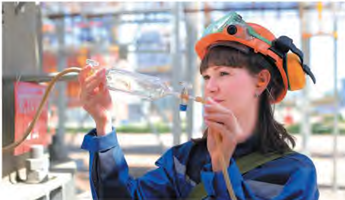
Забор пробы в поглотительную склянку – это будет образец для дальнейших анализов
