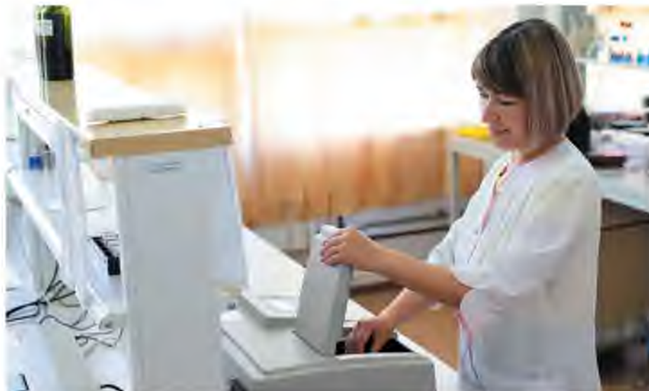
Погружаем пробу в фотокolorиметр – прибор «оценил», насколько ярка окраска
