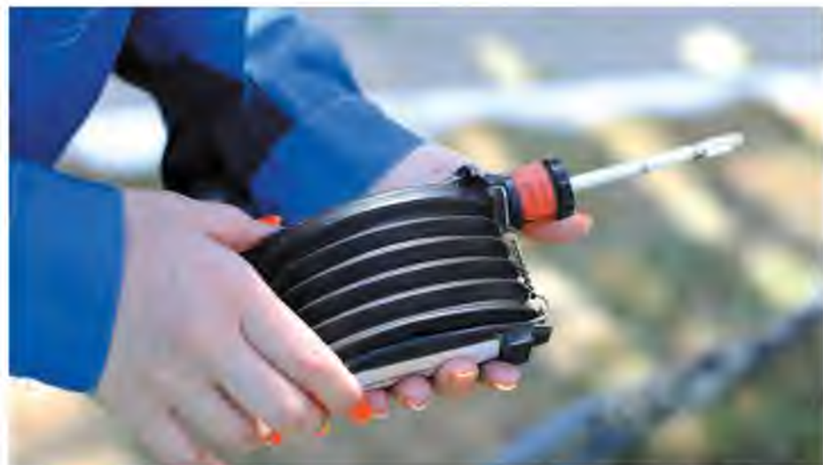
Индикаторная трубка: если она белая – всё чисто, но если окрасится – значит в воздухе есть загрязняющие вещества
